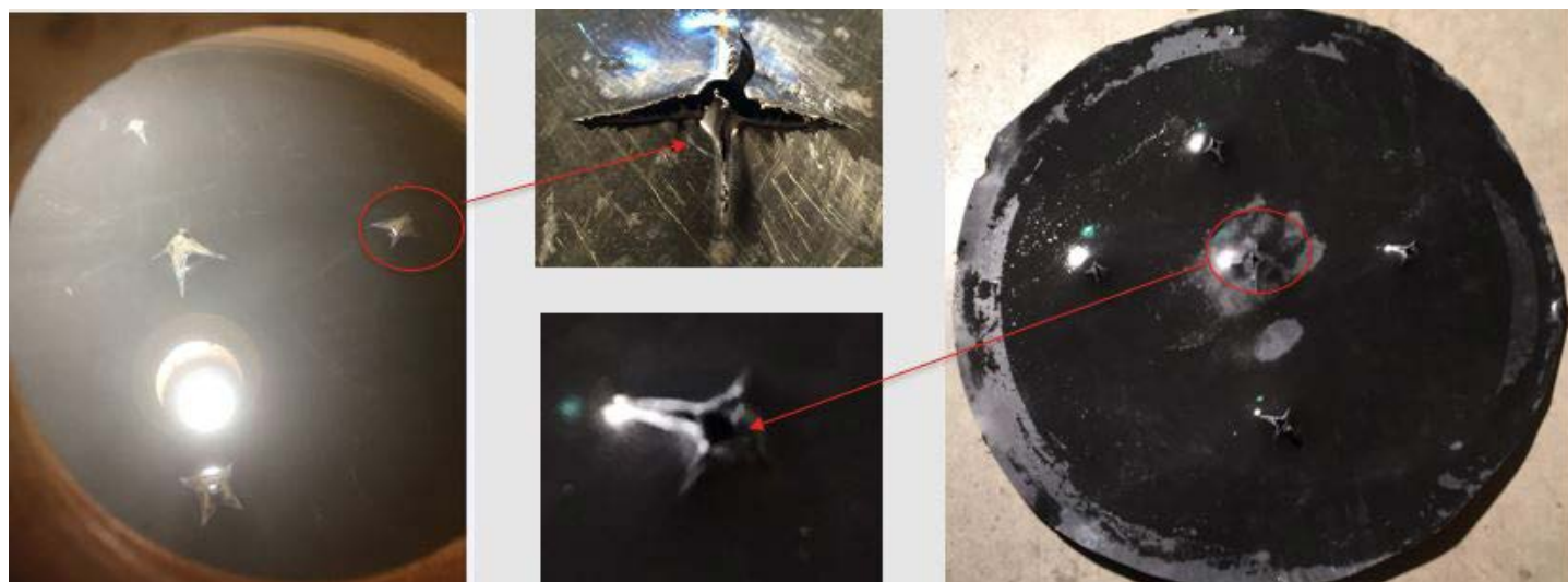
Рис. 4 Образцы ПЭВП мембран в ходе и по окончании эксперимента
