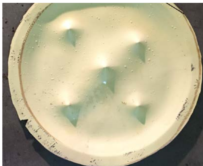
Образец ПВХ-мембраны после снятия нагрузки
